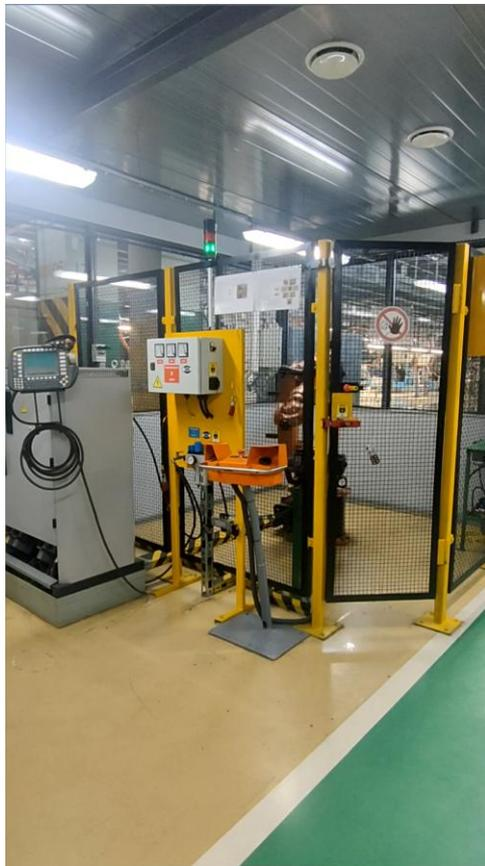
Вход в зону работы робота через сервисную дверь
