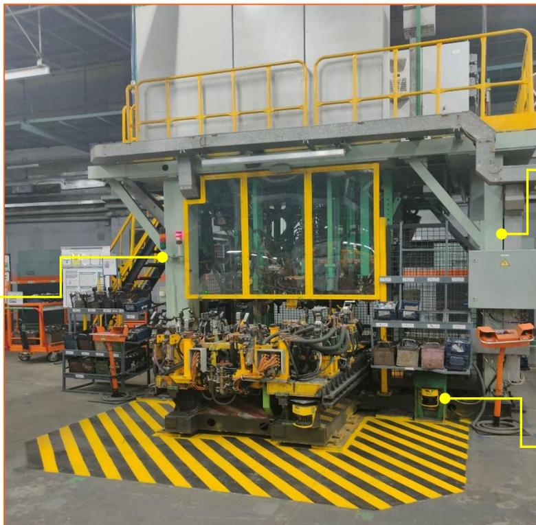
Изготовлены и установлены защитные ограждения, датчики 4-го типа, лазер-сканеры, нанесена сигнальная разметка, реализована процедура LOTO.
