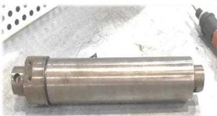
Расположенная на верстаке деталь цилиндрической формы в свободном состоянии – риск падения на ногу
