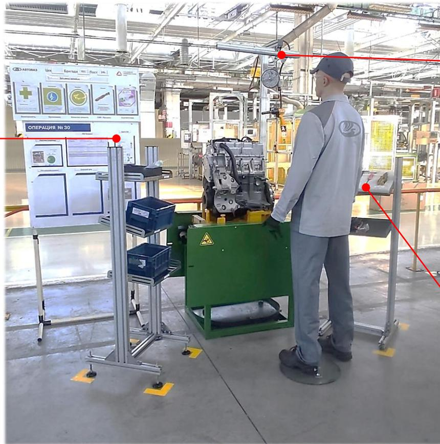
Предохранительное устройство от падения подвешенного инструмента
