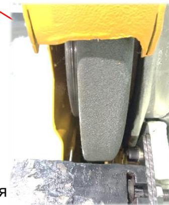
Увеличенный зазор между абразивным кругом и подручником, износ круга, подручника и предохранительного козырька – риск затягивания детали и разрыва круга
